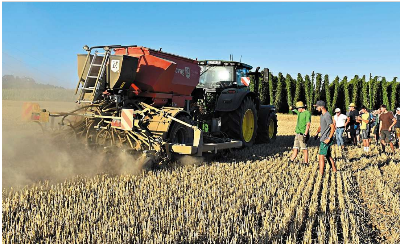
Die Novag-Direktsaatmaschine vereint vier Arbeitsgänge in einem.
